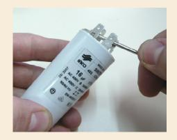
2. Con un téster en posición de resistencia, seleccionando la escala más alta, cargar el condensador haciendo contacto con las pinzas en sus dos terminales. Observaremos que la aguja sube hasta cierto valor.
