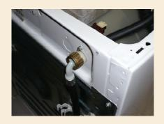
Las electroválvulas pueden ser de una o de varias vías, distinguiéndose por el número de bobinas que tengan en la parte superior. Según la bobina que actúe enviará el agua hacia uno u otro departamento de la jabonera arrastrando el detergente hacia el interior de la cuba a través de un manguito en forma de fuelle.
