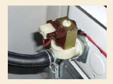
En las lavadoras con electroválvula simple o de una sola bobina, un mecanismo accionado por el programador a través de una biela o de una sirga, conduce el agua hacia uno u otro departamento de la jabonera para que arrastre el aditivo correspondiente a cada punto del ciclo de lavado.
